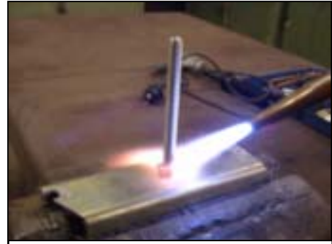
Gleichmäßiges erwärmen beider Bauteile.
