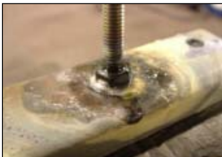
Fertige Lötung aber noch mit Flussmittelresten.
